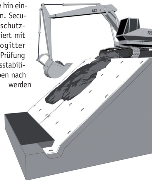
Abb. 12 Einbringen des Bodens mit technischem Gerät
